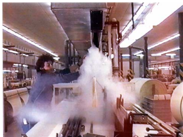
Darstellung des Luftstromes mittels Rauchprobe: Die feuchte Luft wird direkt auf den Fachbildungsbereich der Webmaschine geführt
