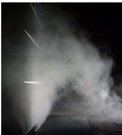
Bild 2: Raumströmungsaufnahme, 45 m 3 /h und -6 K
