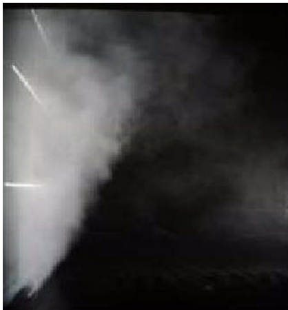
Bild 1a: Raumströmungsaufnahme, Beginn Rauchzugabe, 70 m 3 /h und -4 K
