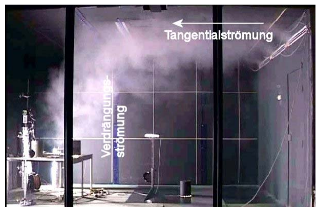
Prinzip Tangentialströmung mit anschließender Misch-/Verdrängungsströmung
