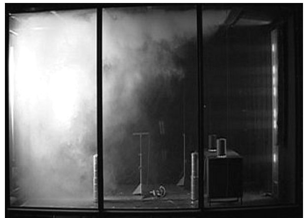
Raumströmungsversuch (Kühlfall) mit dem HDC-Gerät im LTG Labor (LTG Ingenieur-Dienstleistungen).
